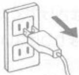
●フィルタを取り出す前に専用回路の電源（住宅用分電盤）を切るか、付属の電源コードをご使用の場合は電源コードを抜いて送風を止めてください。
